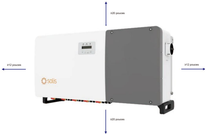
Figure 3.2 Exigences relatives aux distances de dégagement pour l'onduleur
