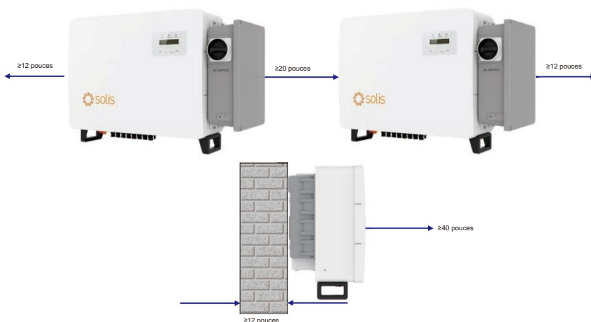
Figure 3.3 Distances requises entre les onduleurs lorsque plusieurs onduleurs sont installés
