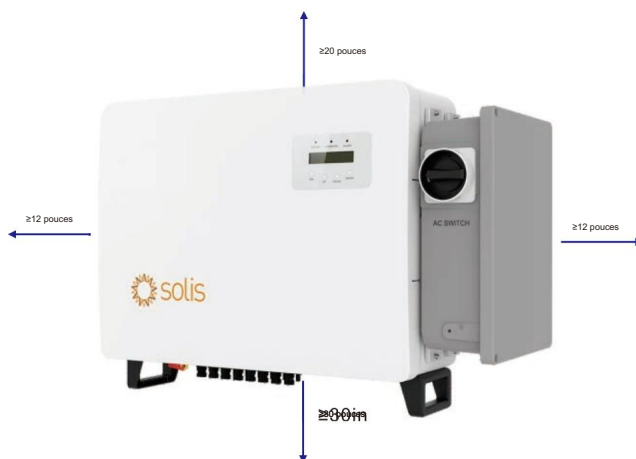
Figure 3.2 Exigences relatives aux distances de dégagement pour l'onduleur
